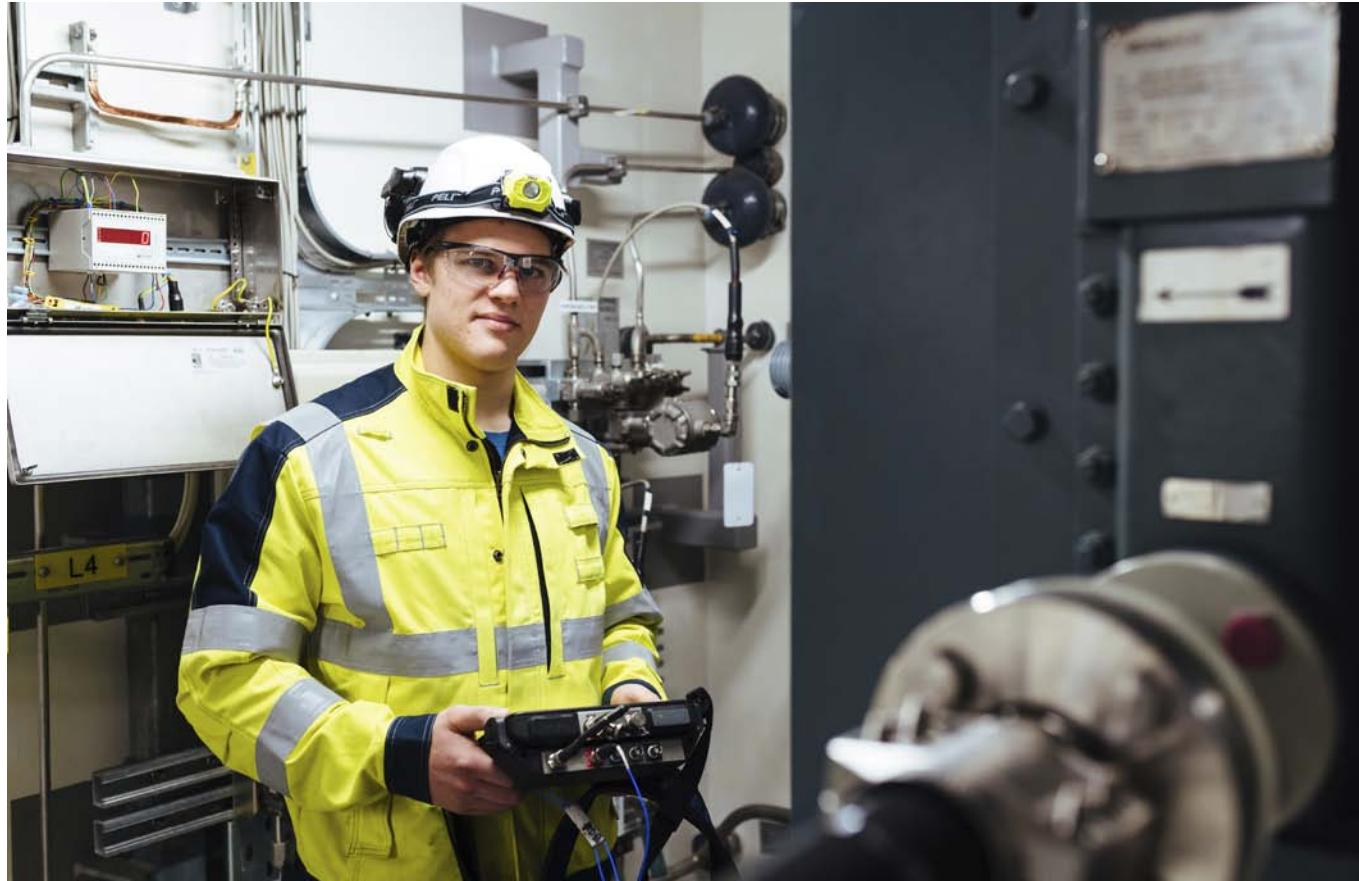
Koneasentajan koulutuksen saanut Jere Sjöblom tekee laadunvalvonnan värähtelymittauksia.
